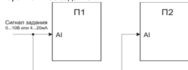
Рис. 2. Параллельная синхронизация по аналоговым входам-выходам
